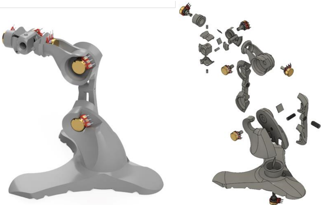
Figura 1. Visão completa e visão “explodida” do braço em miniatura modelado.
