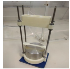
Figura 5 – Fixação dos transdutores
